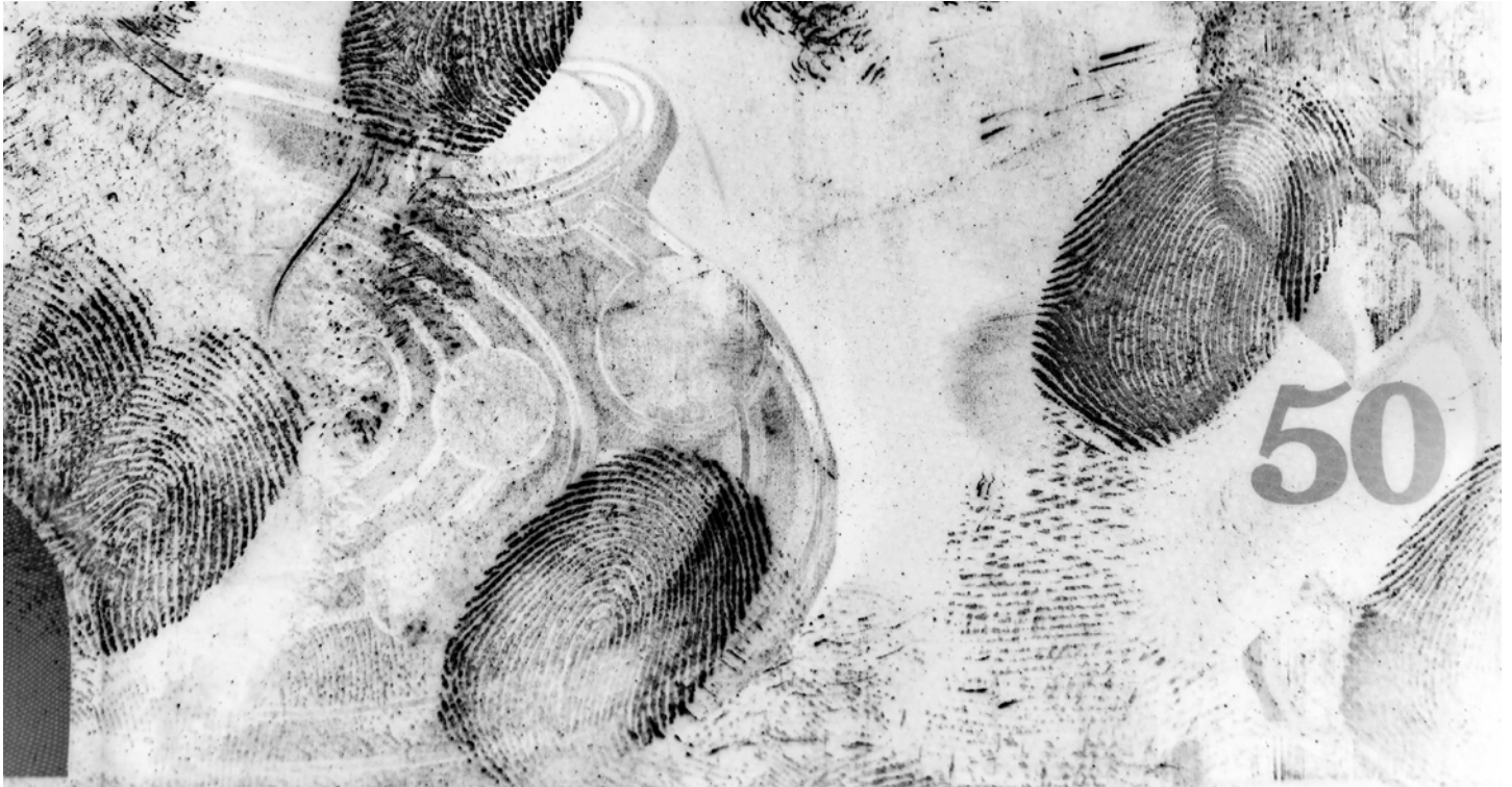
Fingerabdrücke auf einer Polymerbanknote, entwickelt mit Cyanoacrylat
